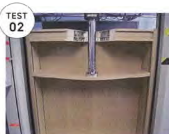
棚板の垂直荷重試験
