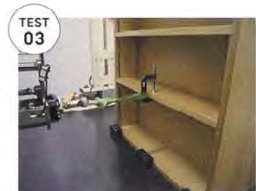
棚板の水平荷重試験
